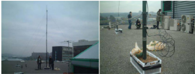
Abbildung 12. Omni-direktionale Antenna, die zur Signalverstärkung des Wireless Netzwerkes des Spieles "Can You See Me Now?" dient.
