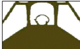
Stencil Maskierung: Nur die weissen Bereiche müssen dauernd erneuert werden, die restlichen Pixel (dunkel) müssen nicht gerendert werden
