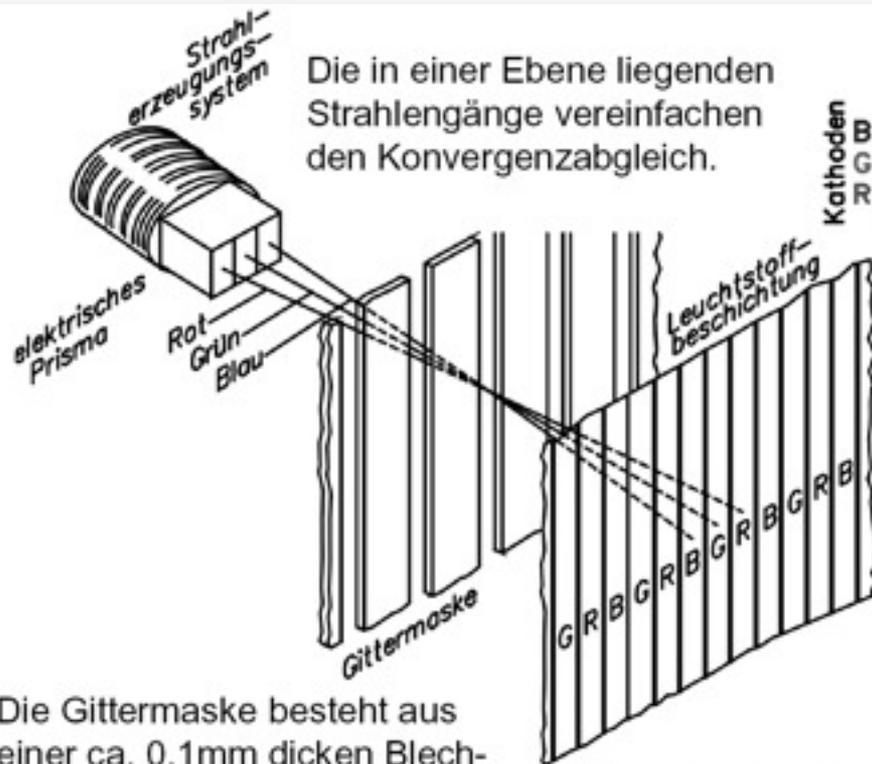
Die Gittermaske besteht aus einer ca. 0.1mm dicken Blechfolie, in die Schlitze eingätzt sind. Mech. Stabilitätsprobleme werden durch horiz.gespannte Drähte vermieden.
