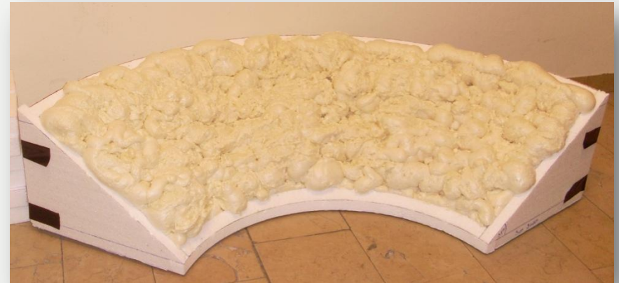
35°-Grundgerüst mit Bauschaum
