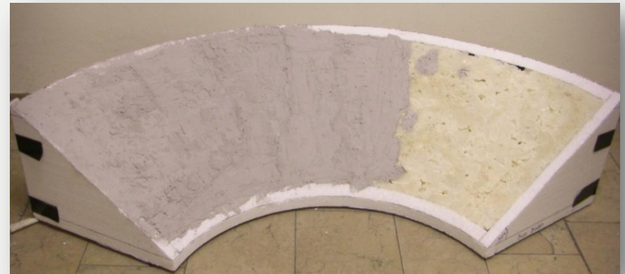
Gipsoberfläche in Arbeit
