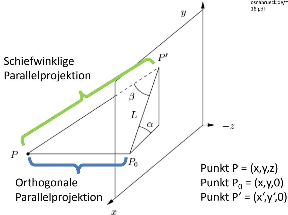
Scherwinkel =  $\alpha$ , Winkel zur Horizontalen, unter dem projizierte Kanten aufgetragen werden.
