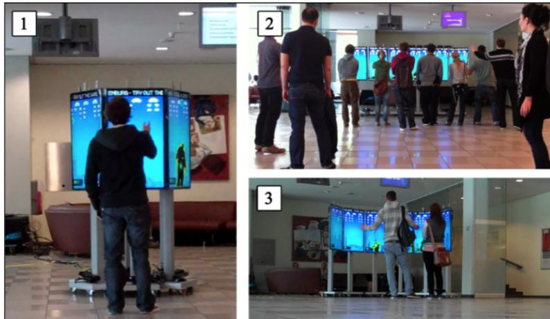
Abbildung 2.2: Unterschiedliche Konfigurationen derselben Bildschirmmenge: Planar/Flach (1), hexagonal (2) und konkav (3)[70].
