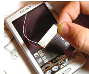
Fig. 15. Piezo bending motor [20]
