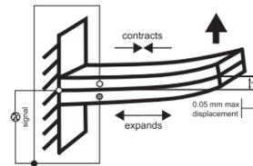
Fig. 14. Piezo bending motor [20]
